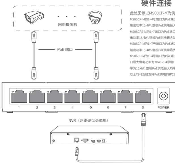
按下表指示灯状态检查是否连接正确。正确完成连接后，交换机不需进行任何设置。
